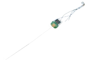
针对大型动物深部脑区的应用，进 行高分辨率的神经信号记录和刺激。
