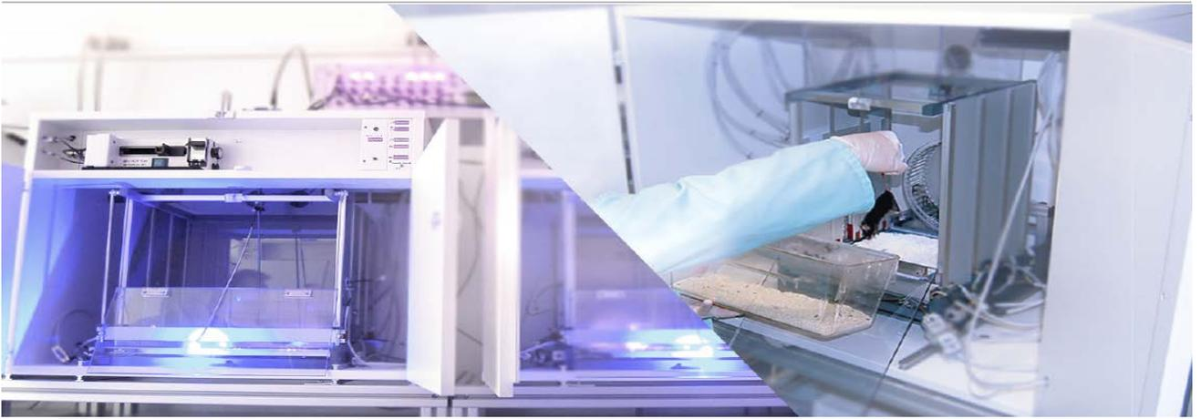
Imetronic的Polymodal系统完全是模块化的，同一套设备可以用于经典条件化，自给药，喂食，五向-CSRTT，大鼠赌博任务等等一系列行为测试任务。Polymodal系统的核心为PolyCage行为笼，可以加配包括给水奖励，声音刺激，视频追踪，自给药，食物奖励，触屏系统，RF天线，压杆，红外光束定位，自动探鼻，5孔探鼻，电击在内的一系列模块，搭配灵活，功能丰富。
