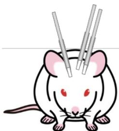
可以将多视场成像光纤插入要测量的不同部分, 从而可以使用一台LumiScope同时进行光度测定。最多可以使用9条多点成像光纤
